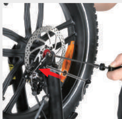
Placer le collier de serrage rapide dans la fente du collier de serrage de la roue avant.
